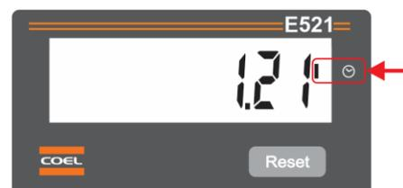
La resolución es de 36 segundos (1/100 horas), o sea, cada incremento del display (0.01) equivale a 36 segundos.
